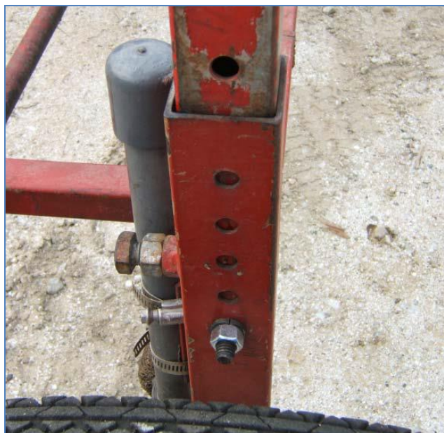
Figure 2. Ajustement de la hauteur par le support des roues
