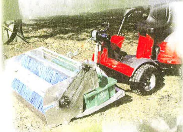
**L'aluminium permet de monter cette cueilleuse sur un petit porteur. Largeur de travail de 44 pouces standard pour 2 boîtes. Un modèle avec 3 boîtes est disponible avec largeur de travail 60 pouces.**
